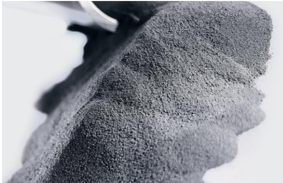
Graphitanoden- material für Batterien
