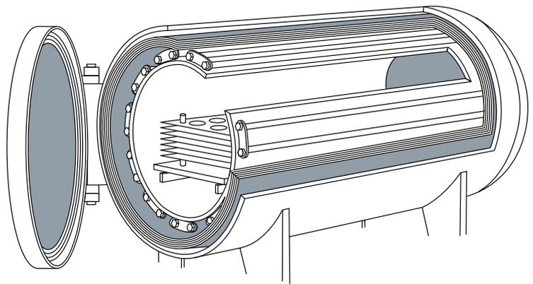
↑ Hitzeschilde – SIGRAFLEX flexible Graphitfolien und Platten werden als reflektierende Hitzeschilde gegen Wärmestrahlung eingesetzt. Die anisotropen Eigenschaften sorgen für eine gleichmäßige Wärmeverteilung über heiße Ofenzonen hinweg.
