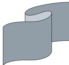
← Trennfolie – Durch den niedrigen Reibungskoeffizient und die gute Biegsamkeit und Wärmeleitfähigkeit eignet sich SIGRAFLEX perfekt als Trennschicht. Die Materialeigenschaften führen zu hoher Effizienz und ermöglichen kurze Turnaround Zeiten.
