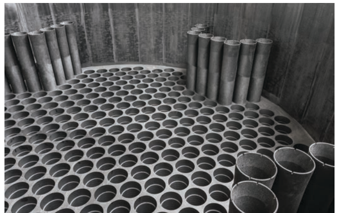
↑ 安装选定管型的 DN2700 DIABON 急冷器
