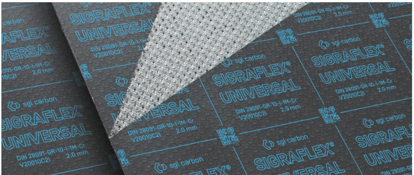
SIGRAFLEX UNIVERSAL 一种不含粘合剂的石墨密封板材, 由柔性石墨箔制成, 带有一个或两个冲孔不锈钢增强。板材经过特殊浸渍防粘处理, 以提高密封性, 同时适合装卸。
