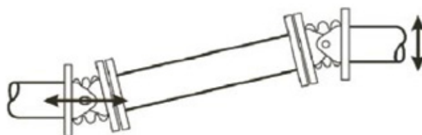
↑ Gelenk- und Gelenk-Langloch-FLUROFLEX Kompensatoren ermöglichen die axiale Bewegung der Kompensatoren in Ergänzung mit angularen Bewegungen.
